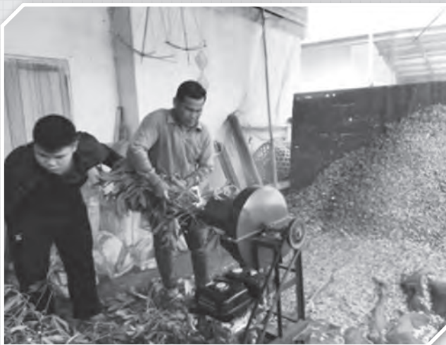
ภาพที่ 2 แสดงการสับใบมันลำเขียวด้วยเครื่องสับขนาดเล็กสำหรับฟาร์มรายย่อย
